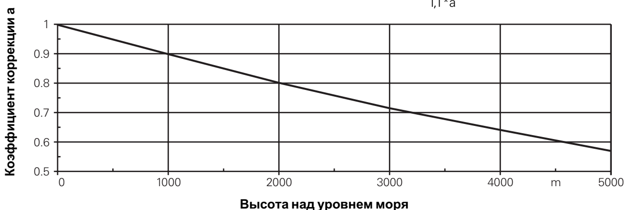
Рис. 3 : Коэффициент коррекции a в зависимости от высоты монтажа
